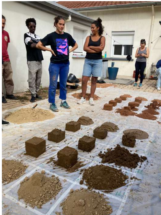
Test de carazas à Lyon, étude du comportement des terres
