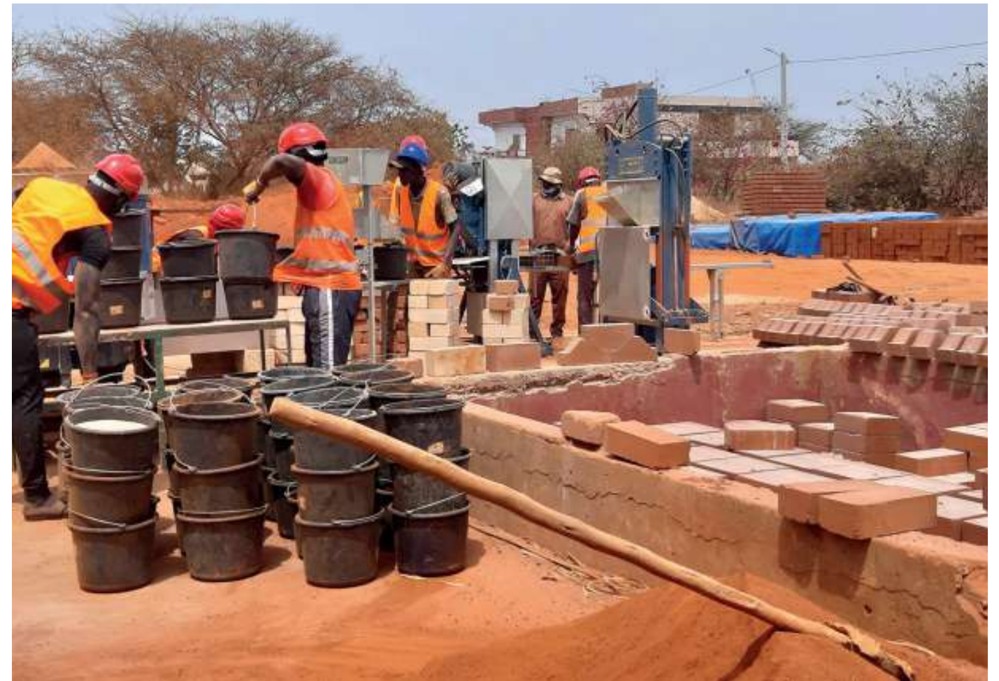
Fabrique de brique de terre crue par Elémenterre à Gzndigal au Sénégal
