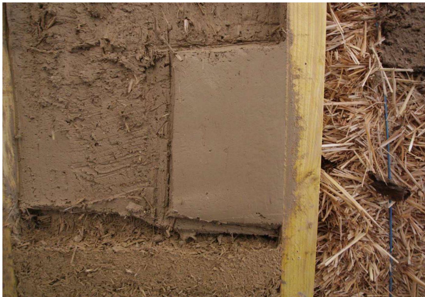
Test d'enduit sur botte de paille
